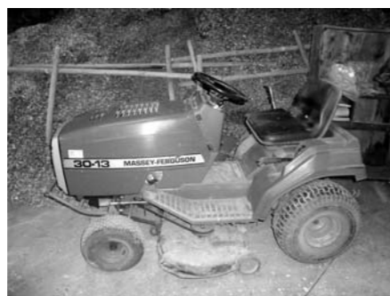
Un tracteur tondeuse (batterie, lame de coupe et carter hors service)
